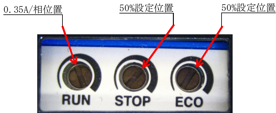
図 4. 3. 7 モータドライバ電流調整ボリューム（0. 3 5 A／相設定）
